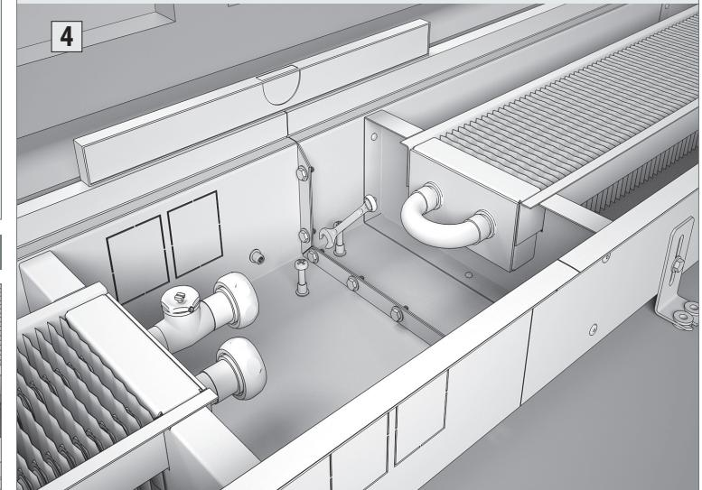
Используя уровнемер, установите корпус конвектора в горизонтальное положение.
