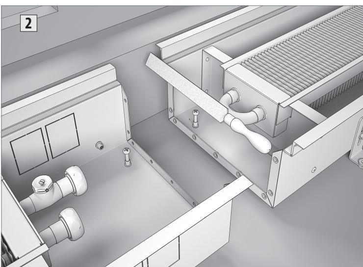
Подведите и выровняйте конвекторы фланцами относительно друг друга так, чтобы декоративная рамка стала "встык" без зазоров.
