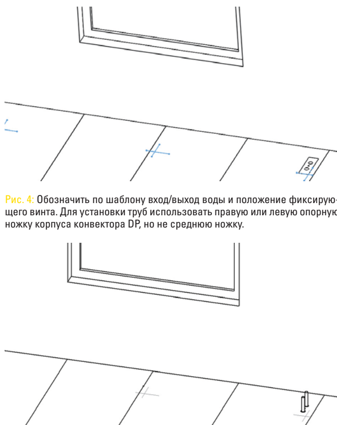
Рис. 5: Просверлить отверстия для крепления корпуса конвектора и подвести в полу подводящие и отводящие трубки теплоносителя.
