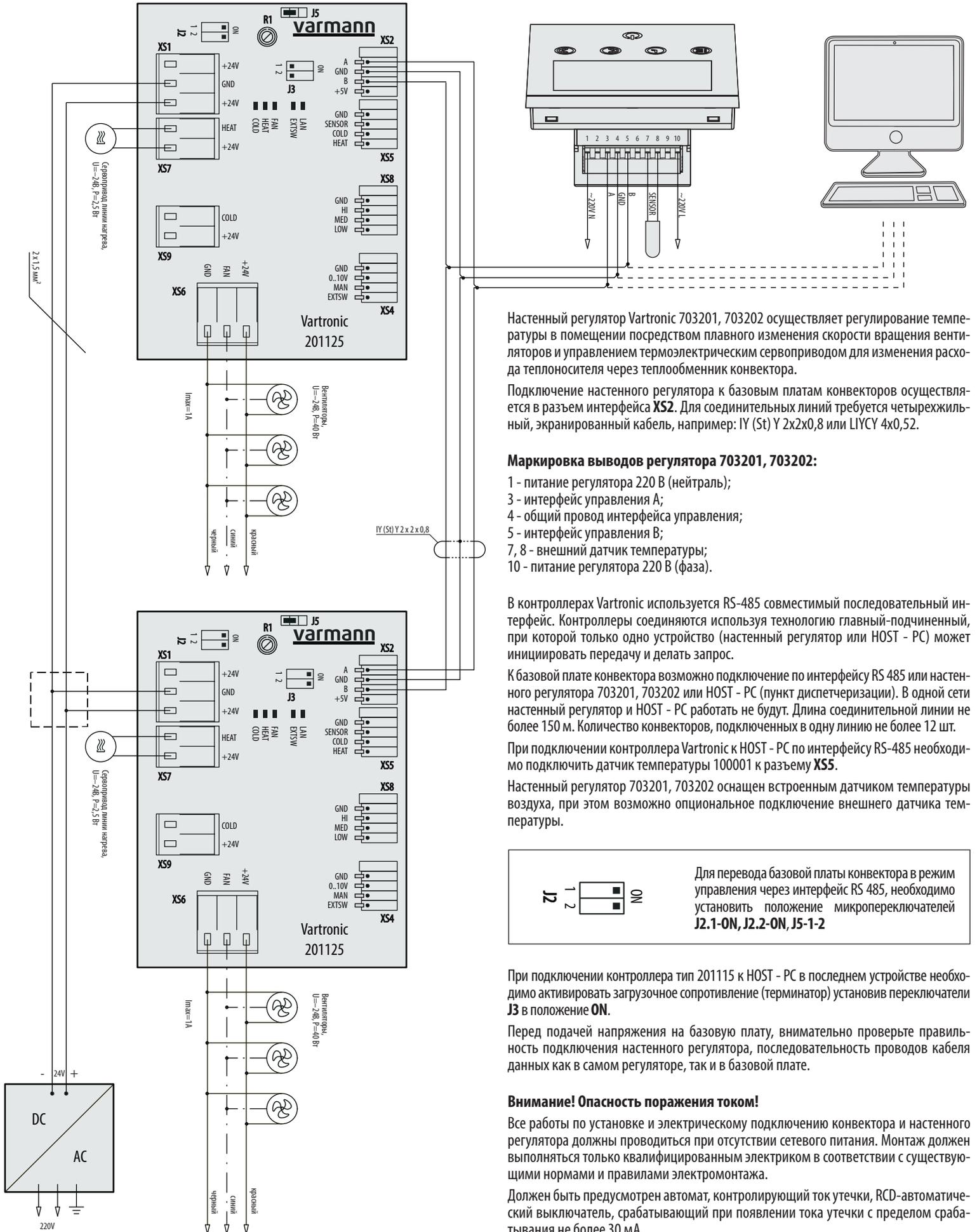
Настенный регулятор Vartronic 703201, 703202 осуществляет регулирование температуры в помещении посредством плавного изменения скорости вращения вентиляторов и управлением термoeлектрическим сервоприводом для изменения расхода теплоносителя через теплообменник конвектора.
