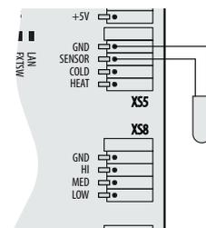
Для перевода базовой платы конвектора тип 201125 в термостатный режим работы, необходимо установить положение микропереключателей **J2.1-ON, J2.2-OFF**
