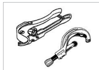
Ножницы и труборезы для полимерных труб REHAU для ровного отрезания полимерных труб диаметром 63-125
