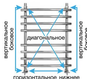
**Боковое подключение для моделей типа «Лесенка»** достигается привариванием двух сгонов с резьбой к одной из двух вертикальных труб, в случаях, когда вертикальное боковое подключение не позволяет получить требуемое межсоединительное расстояние.
