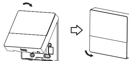
Завершив прокладку кабелей, установите верхнюю крышку корпуса проводного пульта ДУ назад на защёлки.
