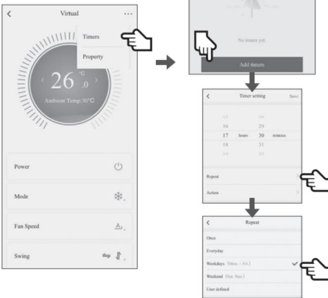
При нажатии на символ «...» в верхней части интерфейса управления вы откроете верхнее меню, в котором расположен таймер и свойства подключенным к приложению устройств. При нажатии на кнопку «**Timers**», вы перейдете к настройке таймера на включение/выключение кондиционера, где вы можете выбрать время включения/выключения устройства, так же настроить дни работы таймера (недельное расписание).
