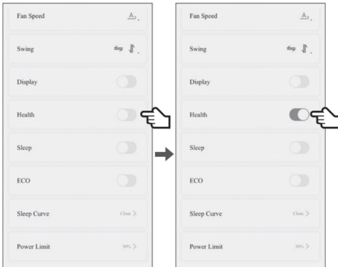
При помощи ползунков, находящихся с нижней части интерфейса управления вы можете так же включать/выключать дисплей внутреннего блока, активировать функцию Ионизации (если кондиционер к нему оснащен), режим комфорного сна, функцию ECO.
