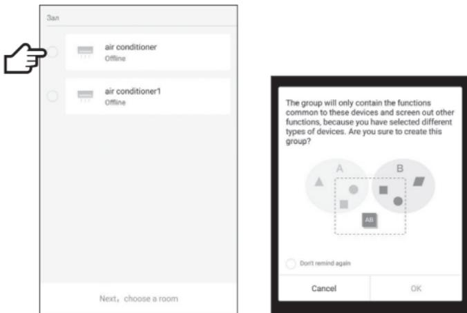
**Примечание:** При добавлении в группу разнотипных сплит-систем (например блоков настенного типа и кассетного типа) группа будет содержать только общие для обеих типов сплит-систем функции. Приложение проинформирует вас об этом и запросит ваше подтверждение.
