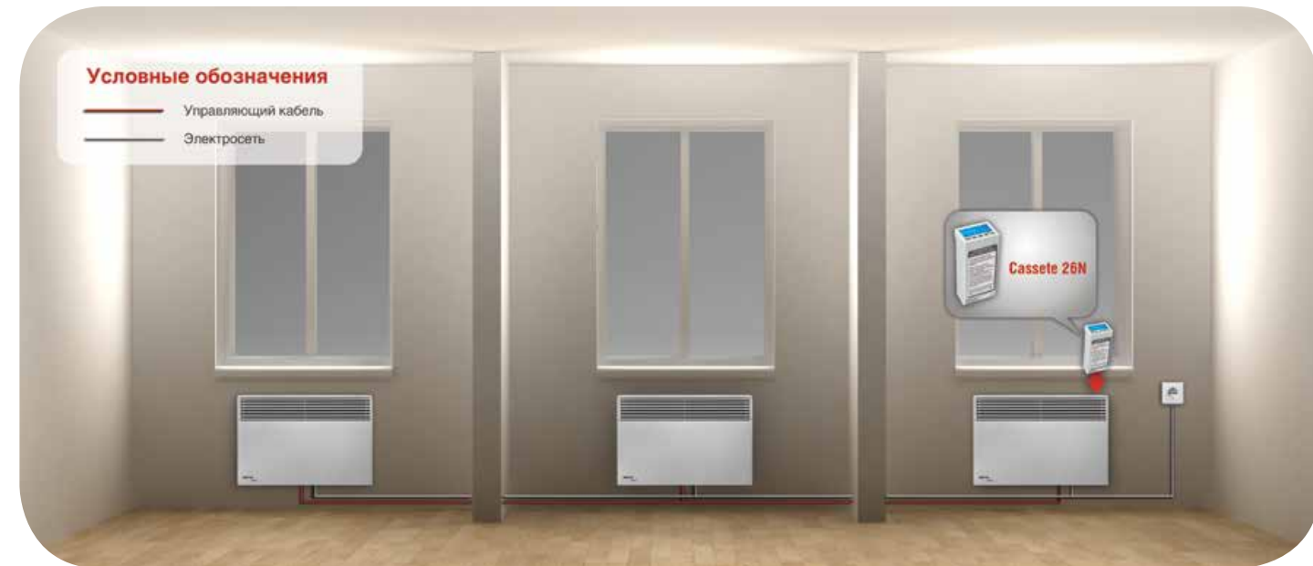
Схема №1. Электрическая система отопления на основе кассеты-программатора Cassete 26N
