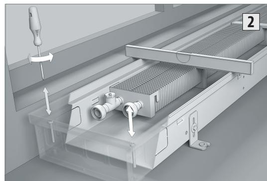
Используя регулировочные винты, по уровню установите корпус конвектора в горизонтальной плоскости в уровень нулевой отметки готового пола.
