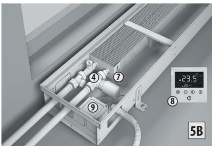
**5B** Схема регулирования комнатным термостатом.
