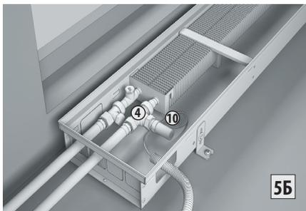
**5B** Схема регулирования термостатом с дистанционной настройкой.
