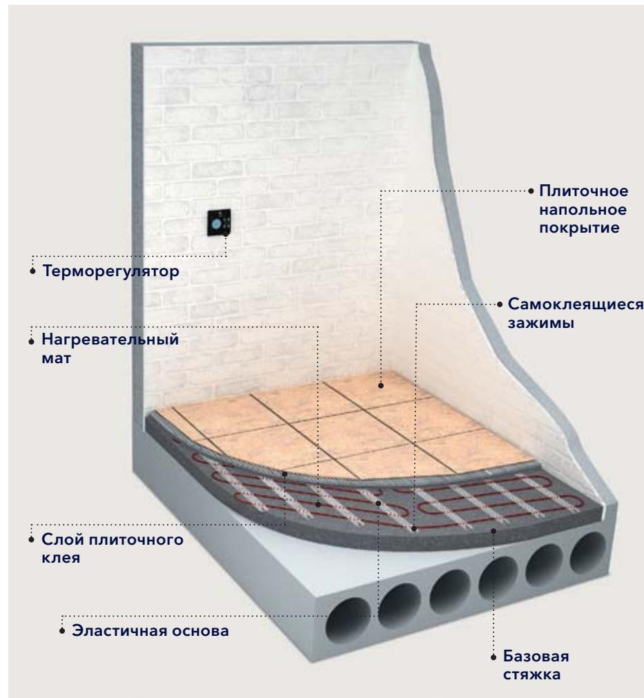
**Вариант установки двухжильного кабеля на площади сложной конфигурации в бетонную стяжку**
